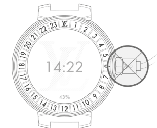
Ne pas positionner le chargeur sous le nombre 6 de votre glace saphir
