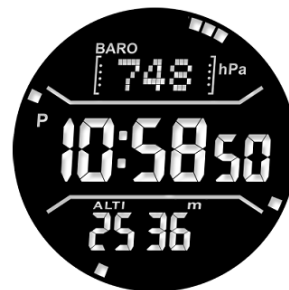
Display monocromatico che mostra in maniera simultanea l'ora e i dati di misurazione (nell'immagine un esempio di pressione atmosferica/altitudine e orientamento della bussola)
